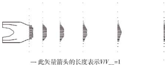
图 6 混合排气喷管对称面上的速度矢量
